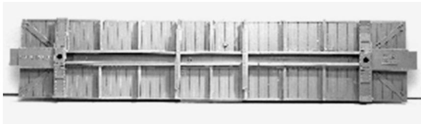
THIS IS THE UNDERFRAME FROM THE USRA SINGLE SHEATH BOXCAR KIT 4026. IT IS TYPICAL OF THE EARLY (1919) STEEL UNDERFRAMES USED ON FREIGHT CARS. IT IS FOR A 40' CAR. IT IS INJECTION MOLDED IN GRAY STYRENE.
